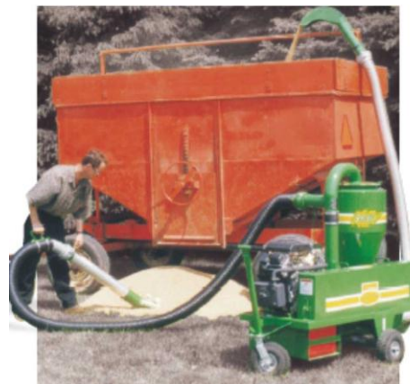
Fig. 2.26 Instalație mobilă pentru descărcare și transport pneumatic
